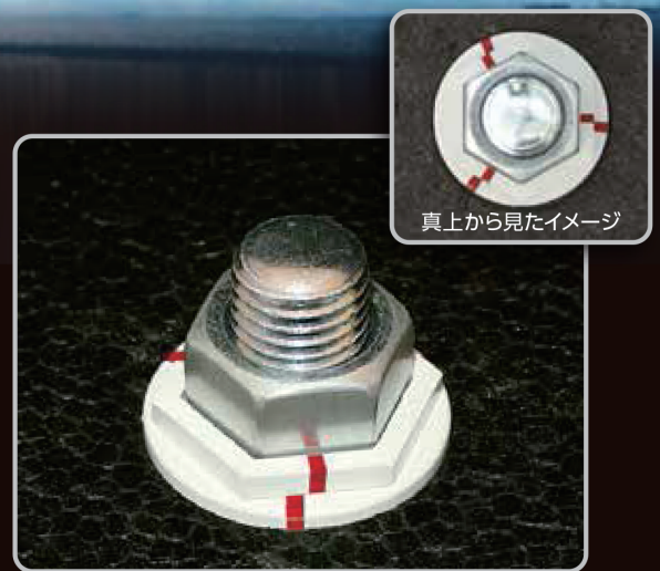
ゆるみ発生 (ラインがずれている)
